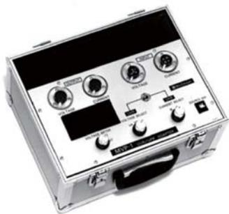
外形寸法・重量 : 340(W) × 270(D) × 190(H)mm・約9.0kg
