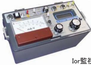
Ior監視装置(監視用Ior)の校正用電流出力にも対応
