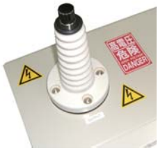
【高圧出力部】 (碍子部分)
