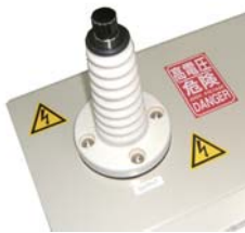
【高圧出力部】 (碍子部分)
