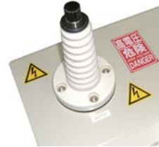
【高圧出力部】 (碍子部分)
