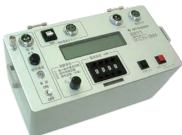
外形寸法・重量 : 245(W) × 130(D) × 146(H)mm ・ 約3kg
