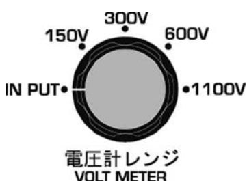
電圧計レンジは、出来るだけ目盛板の2／3付近で読みとれるレンジに合わせてください。
