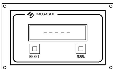
C.CHECK時（電圧が印加されていない。または接点が開）の表示です。
