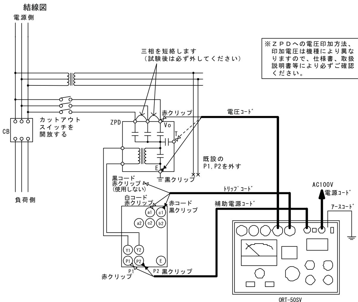
図1 地絡過電圧继電器試験の共通配線（ZPDタイプ）
