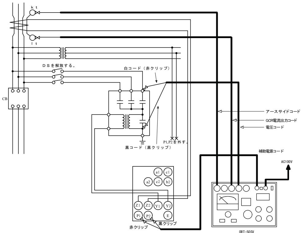
図1 地絡方向繼電器試験の共通配線
