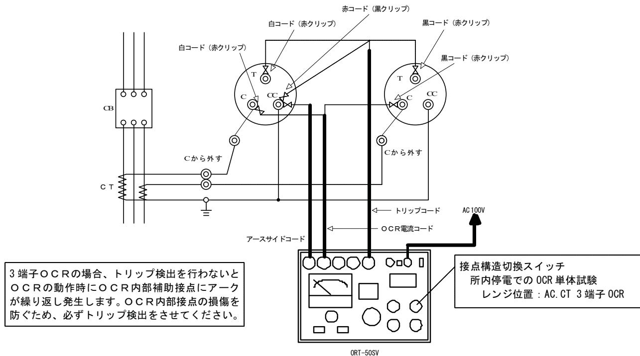
図3 瞬時要素の動作電流特性試験
