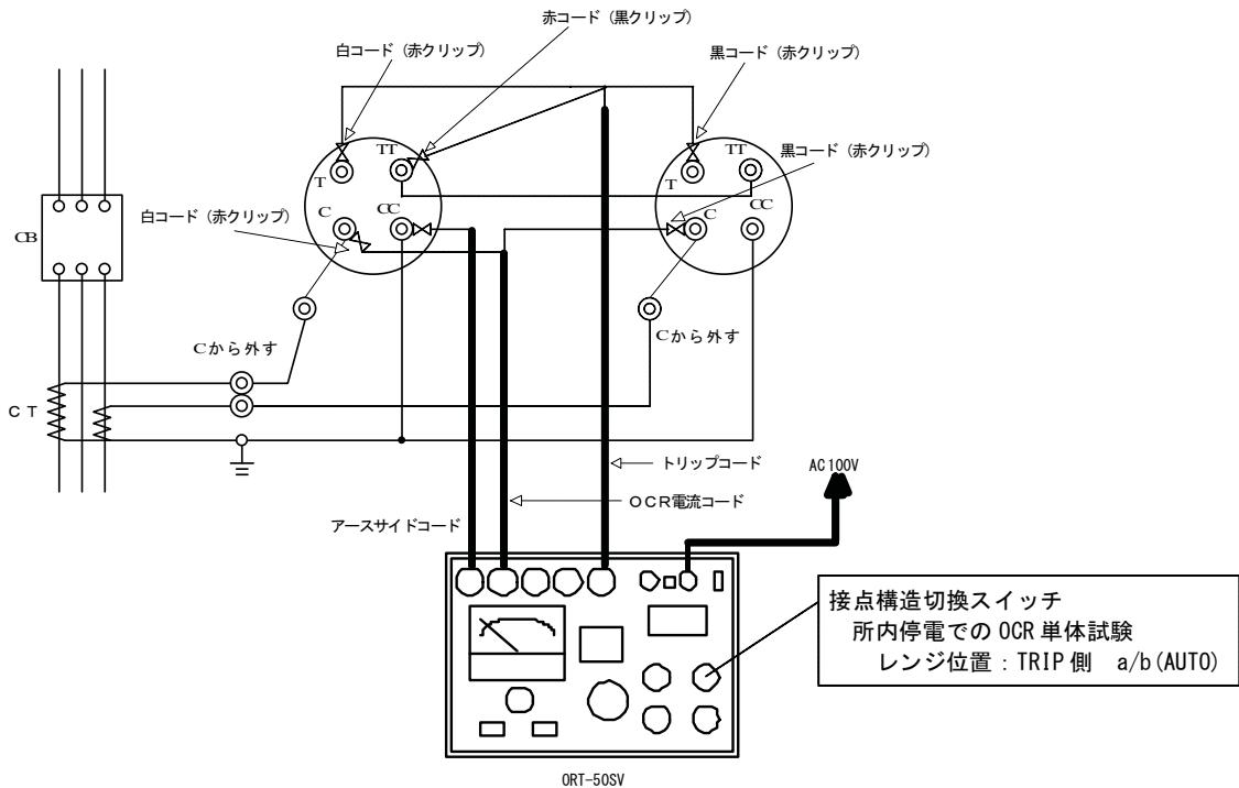
図 16 瞬時要素の動作時間特性試験
