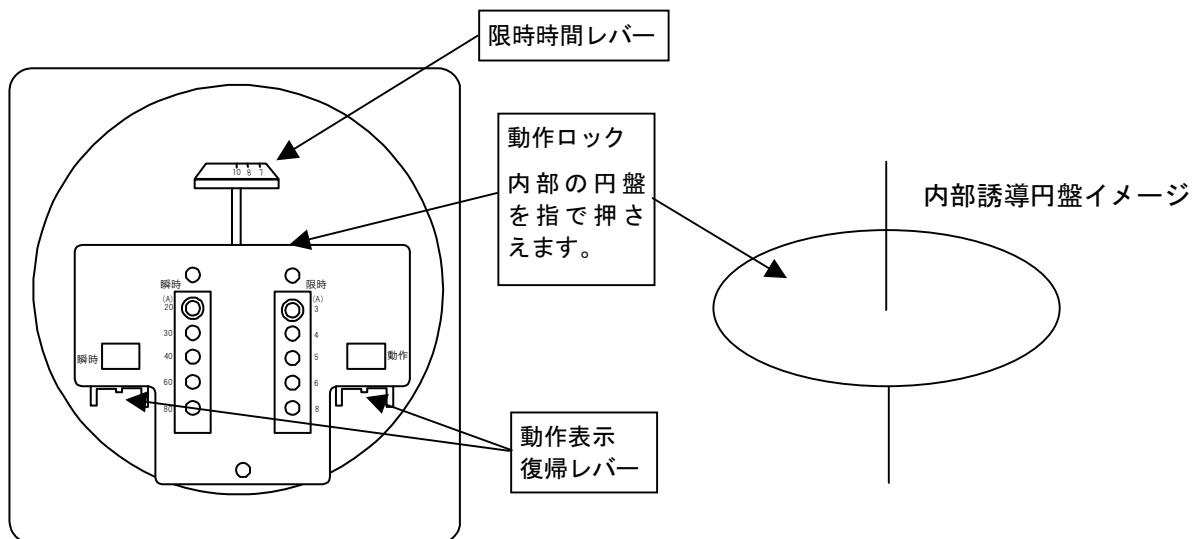
誘導型過電流继電器のパネル例
