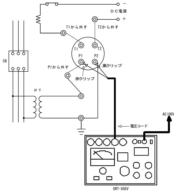
図 1 不足電圧継電器試験の共通配線
