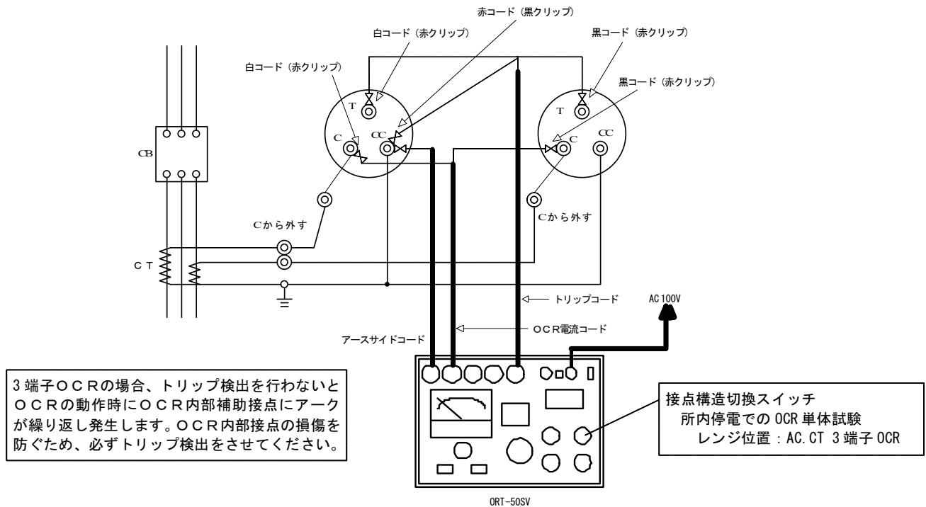
図1 限時要素の動作電流特性試験
