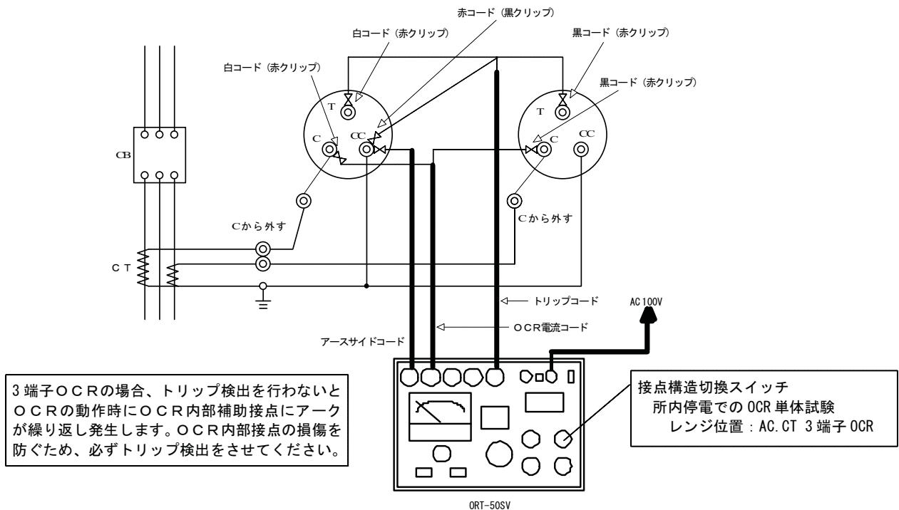
図4 瞬時要素の動作時間特性試験
