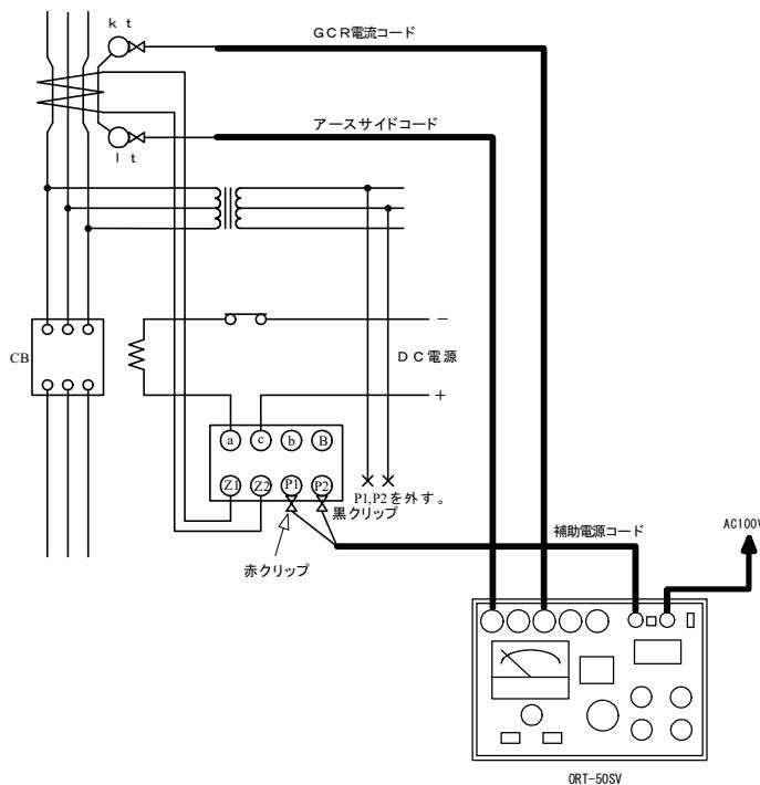
図1 地絡継電器試験の共通配線
