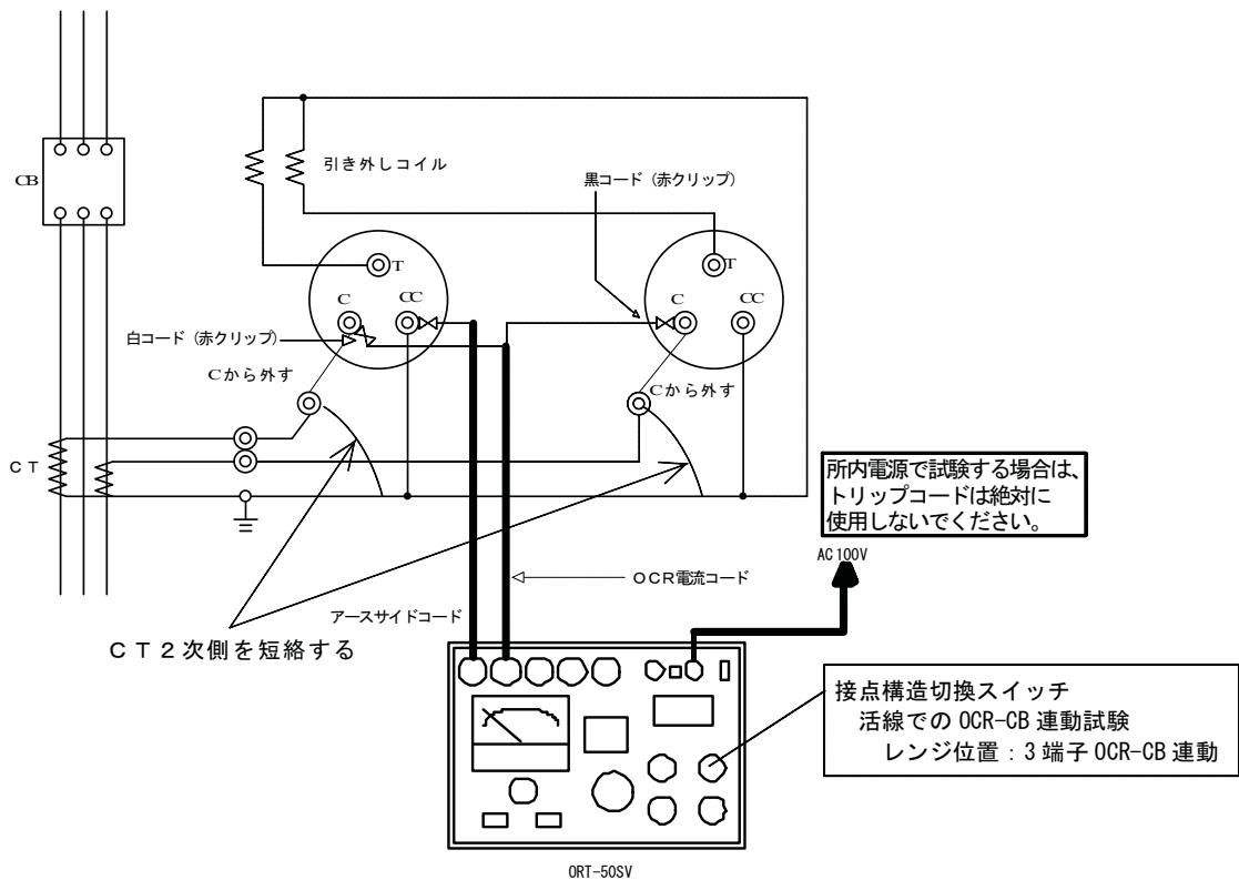
図9 CB運動での限時要素動作電流試験
