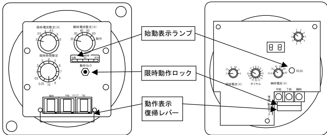
静止型過電流继電器のパネル例
