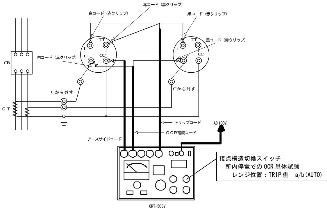
図 15 瞬時要素の動作電流特性試験
