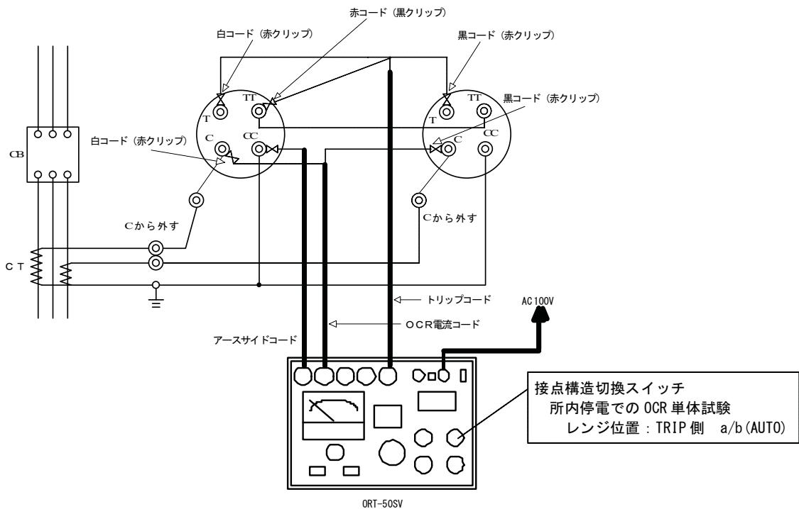
図 13 限時要素の動作電流特性試験
