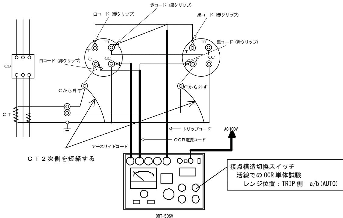
図 19 瞬時要素の動作電流特性試験
