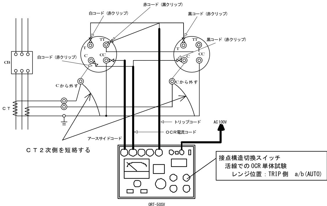
図 2 O 瞬時要素の動作時間特性試験
