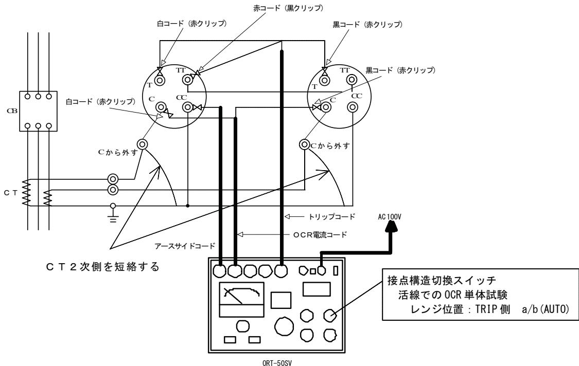
図 17 限時要素の動作電流特性試験
