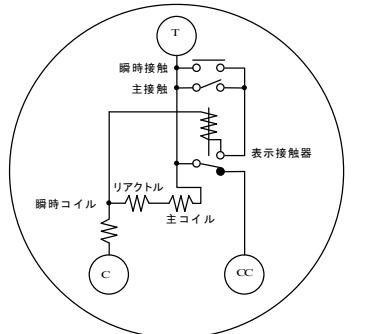
電流引き外し方式：3端子OCR
