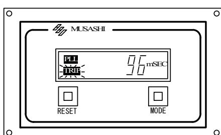
繼電器が動作して、トリップ機能が働いた状態の時、表示値は動作時間を表示しています。
