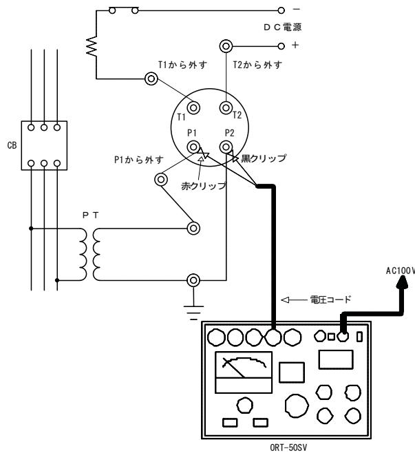
図 1 過電圧継電器試験の共通配線
